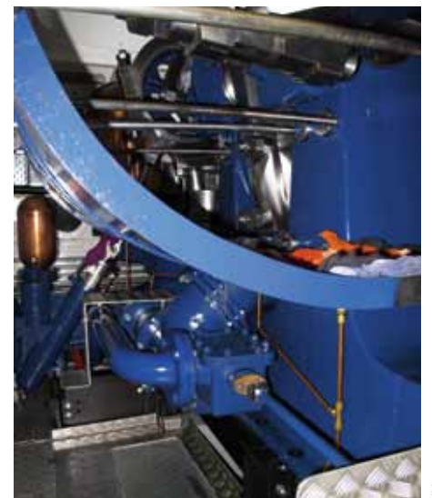
Abdampf gebogene Rohrleitung, Wassereinspritzhahn und Rohrleitung zu Luftpumpe.
